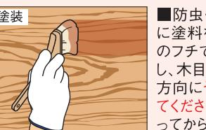
■防虫・防腐用刷毛に塗料を含ませ、容器のフチでタレを調整し、木目に沿って一定方向にうすく塗り広げてください。1回目を塗ってから2時間以上乾燥させ、2回目を重ね塗りしてください。
