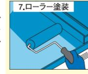
■広くて平らな面はローラーが便利です。ローラーを受け皿の上で数回ころがしてたっぷり塗料を含ませ、一度に塗れる面積の目安をつけて「くぼり塗り」し、その後一度ローラーを受け皿に戻し、塗料の含み具合を調節して上下に一緒に塗り広げます。(上塗り塗後、マスキングテープは塗膜が手につかなくなった場合に内側に向けてゆっくりはがします)
